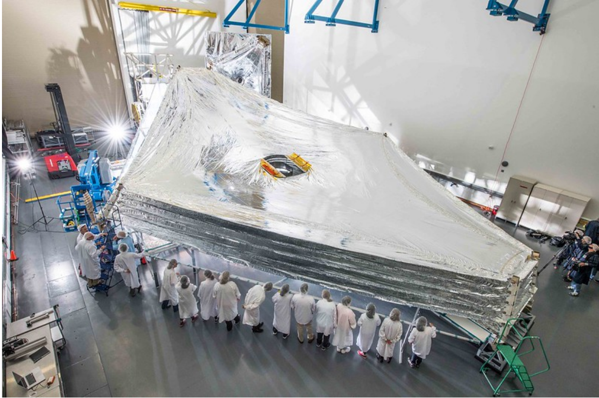
Obrázek 39: Radiační štíty pro Webbův teleskop [17]
