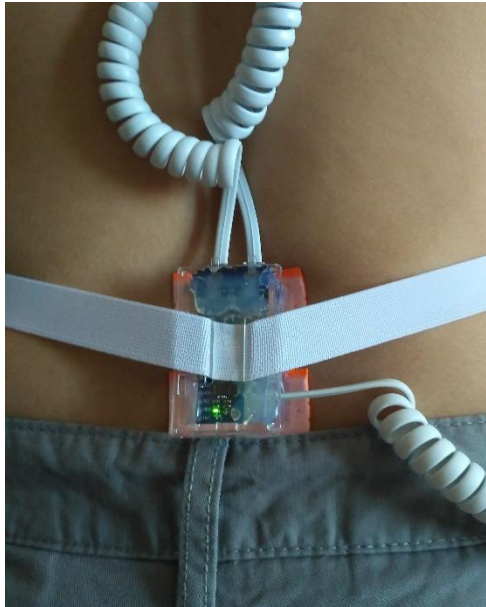
Obr. 20: Uchycení bederního senzoru
