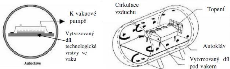
Obr. 5.6 Schéma vytvrzování v autoklávu [4]
