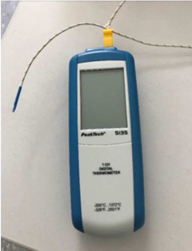
Abbildung 7: Thermometer zur Erfassung der Raumtemperatur (PeakTech, 2014)
