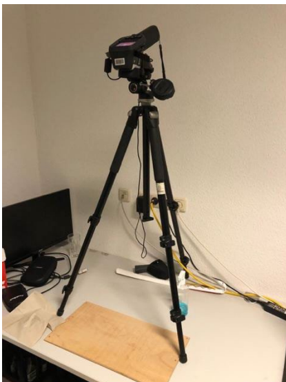
Abbildung 8: Thermokamera mit Stativ (Flir)
