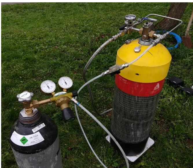
Obrázek 2. Tlaková lahev s přípravkem BLUEFUME
