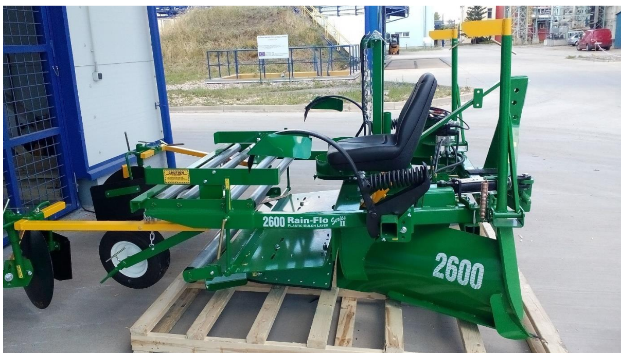
Obrázek 6. Shank – přístroj pro aplikaci EDN do půdy
