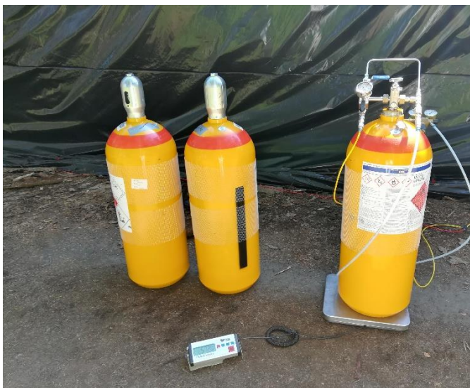
Obrázek 1. Tlaková lahev s přípravkem EDN
