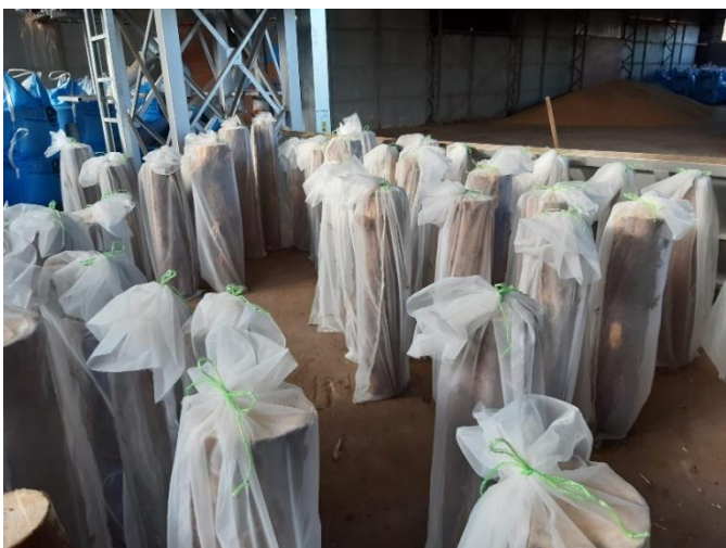
Obrázek 9. Zabalená smrková kulatina, určená pro kontrolu účinnosti přípravku EDN na lýkožrouta smrkového
