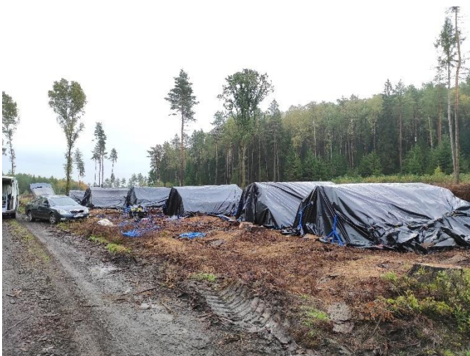
Obrázek 9. Zabalená smrková kulatina, určená pro kontrolu účinnosti přípravku EDN na lýkožrouta smrkového
