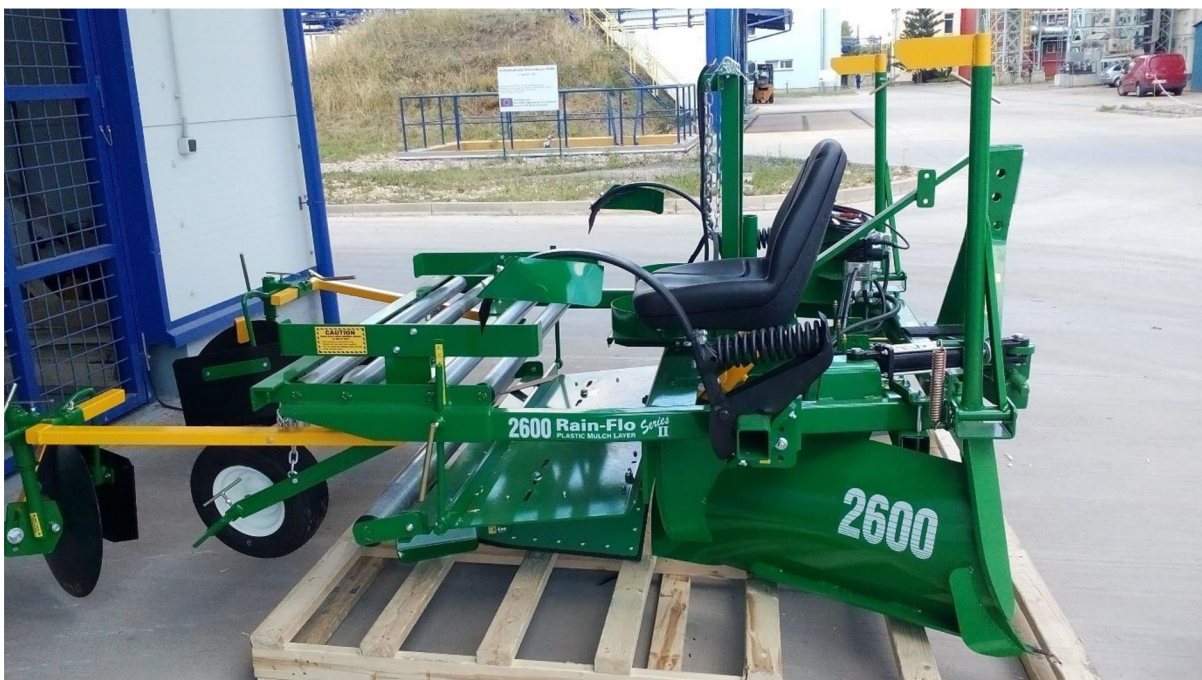
Obrázek 6. Shank – přístroj pro aplikaci EDN do půdy
