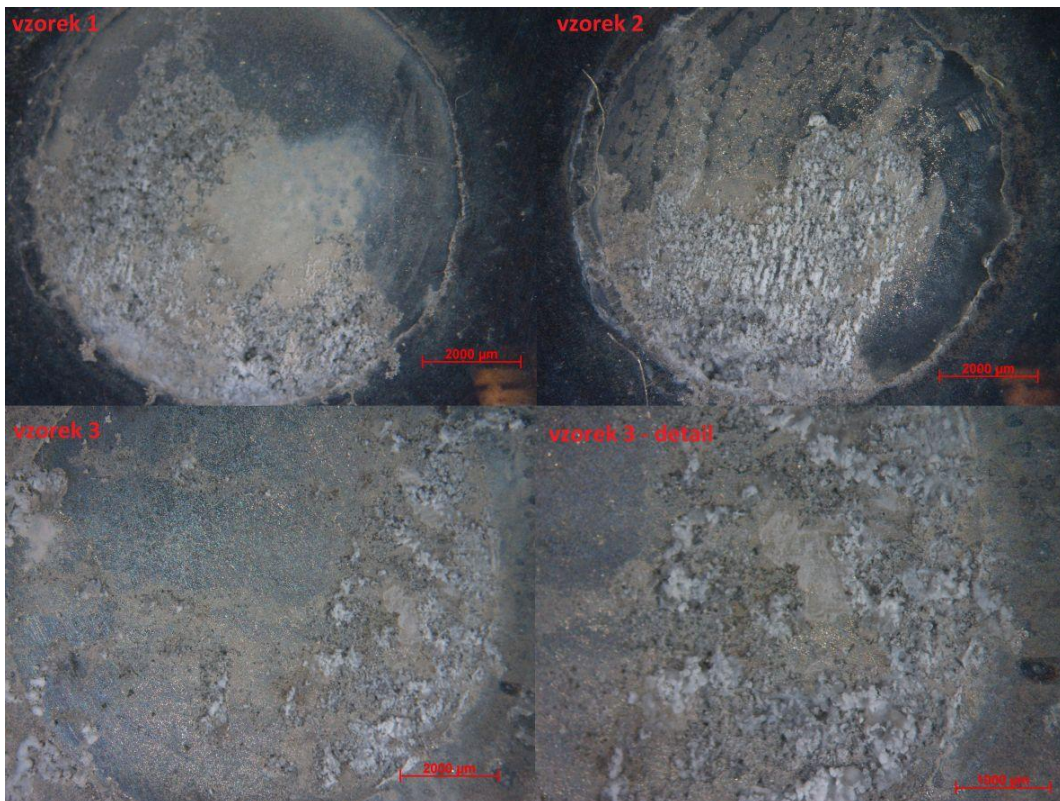
Obrázek 23 Snímky leštěného povrchu lité slitiny AZ61 po 168 hod v roztoku 0,1M NaCl
