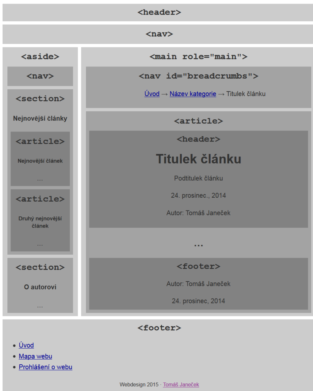
Obrázek 9 – Kompletní grafický náhled sémantické struktury realizované HTML5 stránky
