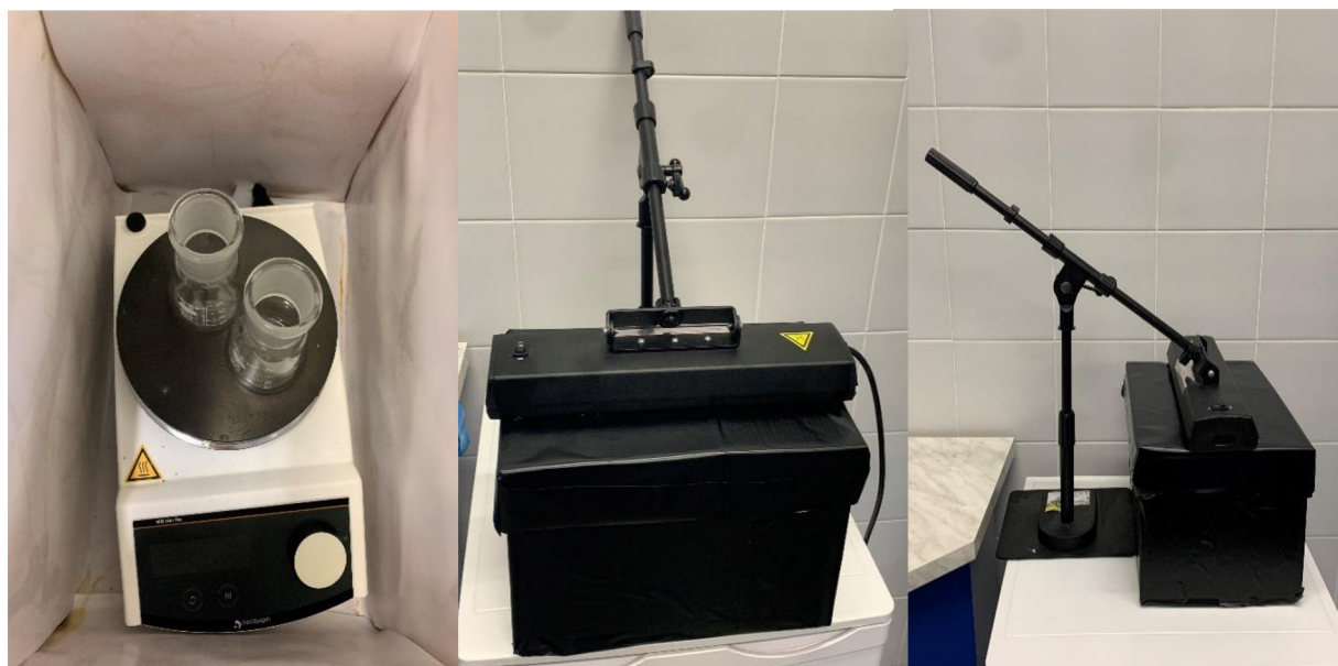
Obrázek č.9 - Box se zvýšenou vnitřní odrazivostí pro fotokatalytický experiment.
