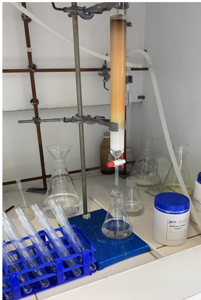
Obrázek č.10 - Kapalinová chromatografická kolona.
