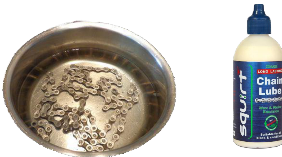
Obrázek 3.4-5 Nalevo parafínová lázeň, napravo kapátkový aplikátor [38]
