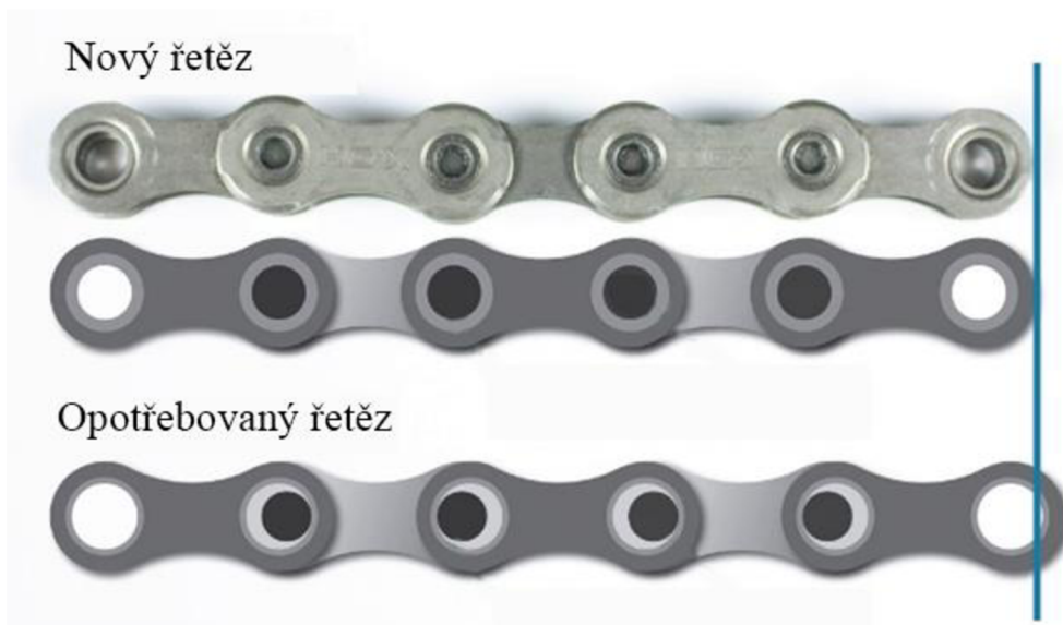
Obrázek 3.3-8 Zobrazení opotřebení řetězu [37]
