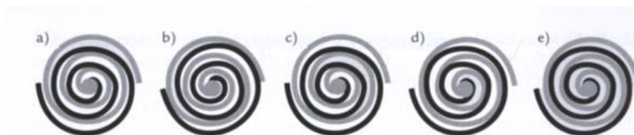
Obrázek 3: Princip fungování kompresoru scroll [3]
