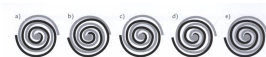
Obrázek 3: Princip fungování kompresoru scroll [3]
