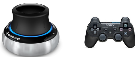
Obrázek 2.4: Ovládací zařízení 3D connexion space navigator a a gamepad b
