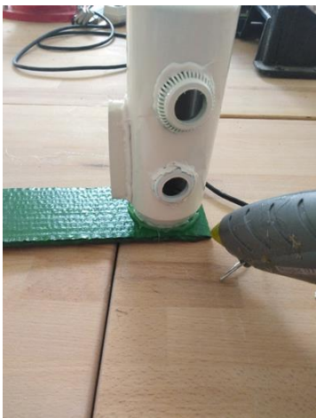
Obr. 75 Přilepení plechovky k podkladu
