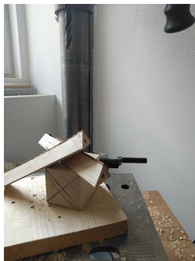
Obr. 85 Otvory pro čepy
