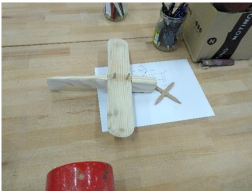
Obr. 98 Usazení křidel do trupu
