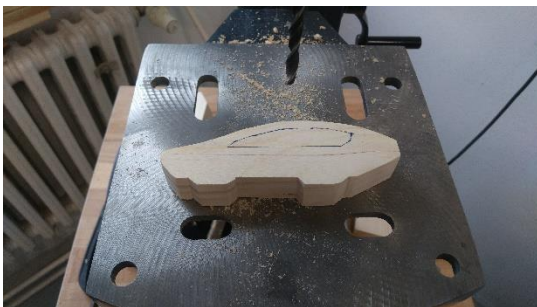
Obr. 23 Vyvrtání otvoru pro řezání lupénkovou pilou
