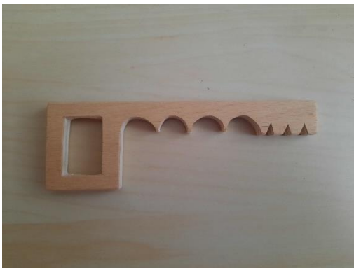
Obr. 52 Vyřezané a opracované madlo
