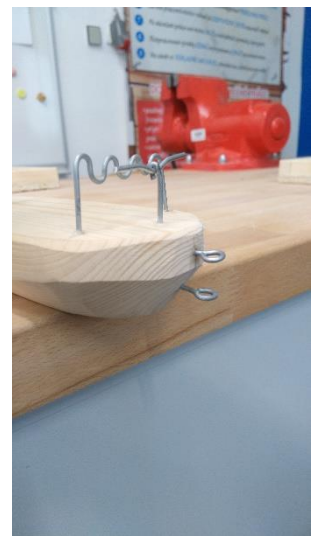
Obr. 112 Usazení držáků kormidla
