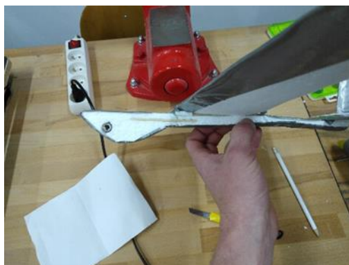
Obr. 47 Vyztužení trupu boční části
