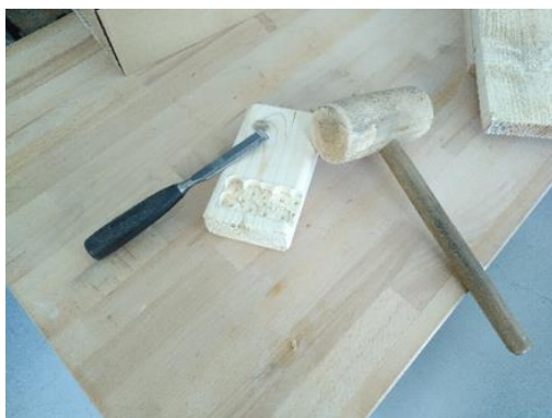
Obr. 84 Začištění prostoru na baterie
