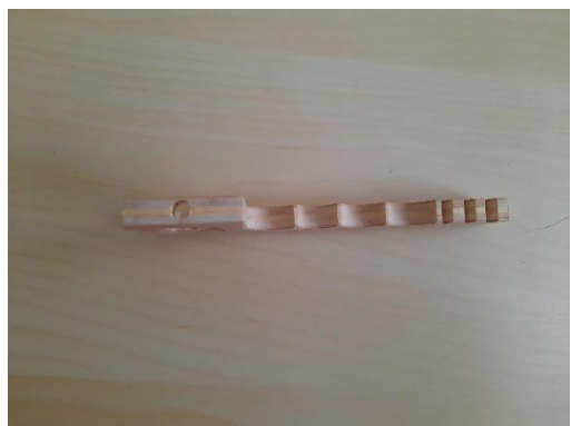
Obr. 53 Provrtaný otvor pro kolík
