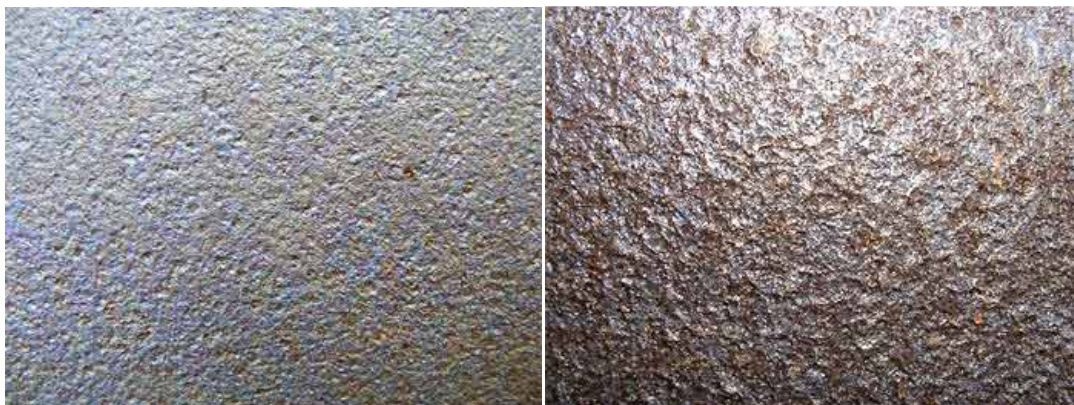
Obr. 4.2 Příklad vzhledu ochranné patiny na konstrukcích v ČR po cca 25 letech expozice [7]
