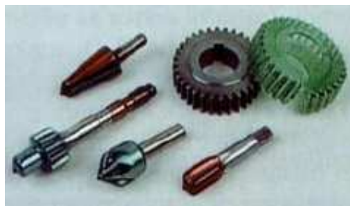
Obr. 2.10 Nástroje a konstrukční díly chráněné transparentním lakem[6]
