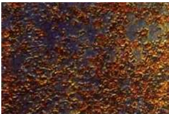
Obr. 2.1 Rez na hladké oceli[6]
