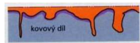
Obr. 2.7 Bodová a důlková koroze[6]
