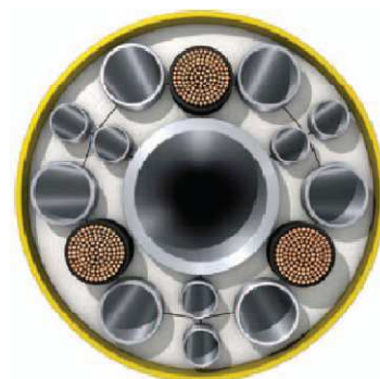
Obr. 6.2 Schematický řez těžebním kabelem [8]
