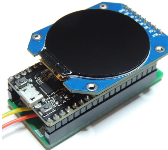
Obrázek 6.4 Osazená deska plošného spoje s připojeným mikrokontrolérem a displejem.
