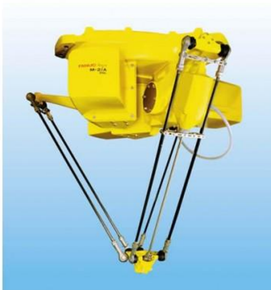
Obrázek 7.: Robot s paralelní kinematikou Fanuc M-2iA [24]
