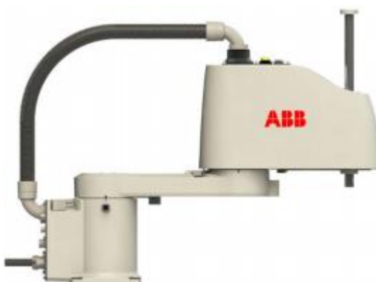
Obrázek 8.: SCARA robot od výrobce ABB [26]
