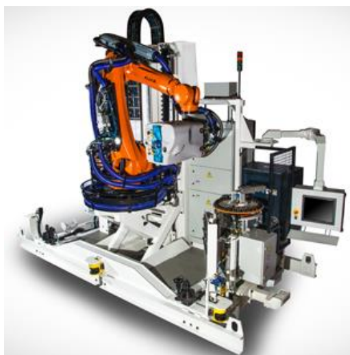
Obrázek 23.: Multifunkční efektor KUKA, využívaný k vrtání při stavbě letadel [38]
