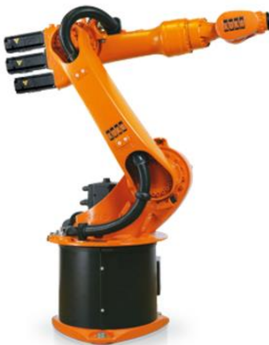
Obrázek 9.: Průmyslový robot KUKA KR 16 [28]
