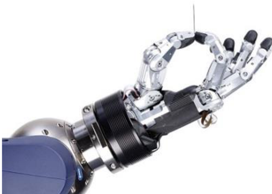
Obrázek 19.: Speciální efektor, mechatronická 5prstá uchopovací ruka SVH firmy Schunk [43]
