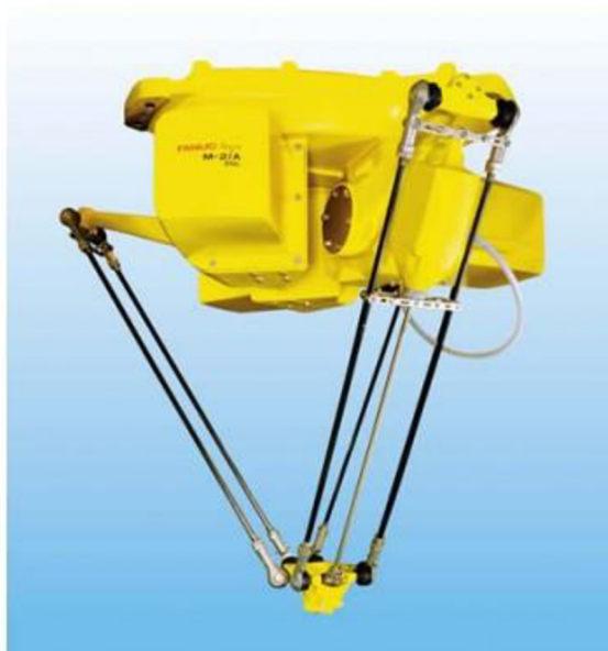
Obrázek 7.: Robot s paralelní kinematikou Fanuc M-2iA [24]
