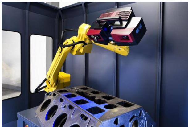
Obrázek 22.: Skenovací hlavice ATOS [37]
