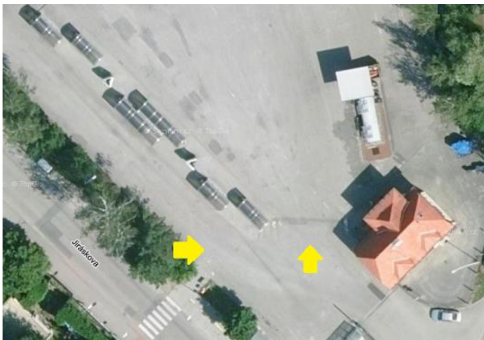
Obr. č. 58: Poškození vodorovného dopravního značení – přechodů pro chodce (zdroj: https://mapy.cz/dopravni?x=14.7649653&y=49.0078754&z=20&l=0&base=ophoto )
