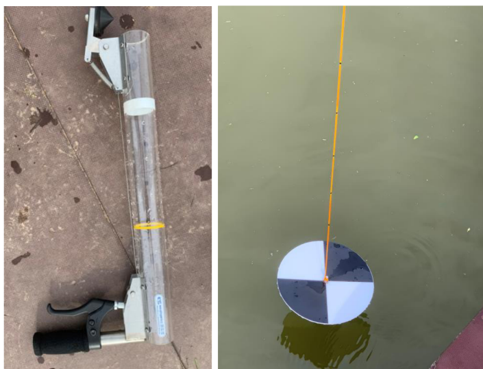
Obrázek 7: Andělova tyč (vlevo), Secchiho disk (vpravo)
