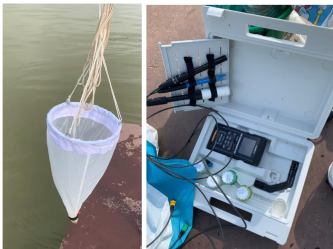
Obrázek 8: Planktonní síť (vlevo), Víceparametrový přístroj WTW Multi 3620 IDS (vpravo)
