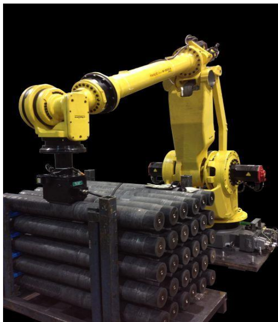
Obr. 10) Magnetický manipulační koncový efektor [18]
