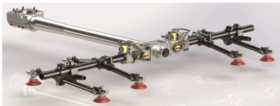
Obr. 8) Pasivní podtlakový manipulační koncový efektor [16]
