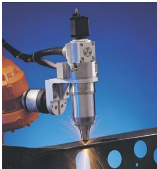
Obr. 11) Technologický koncový efektor k dělení materiálu [19]
