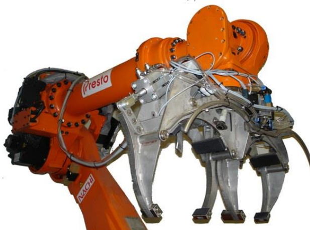
Obr. 7) Mechanický manipulační koncový efektor [15]
