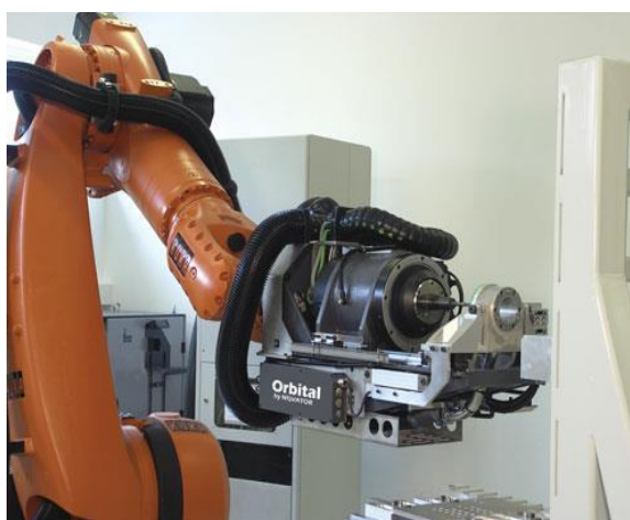
Obr. 12) Technologický koncový efektor k obrábění materiálu [20]
