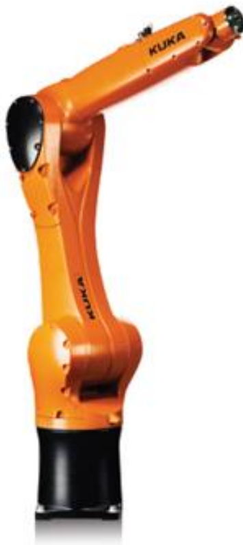
Obr. 1) Šestiosý průmyslový robot [11]
