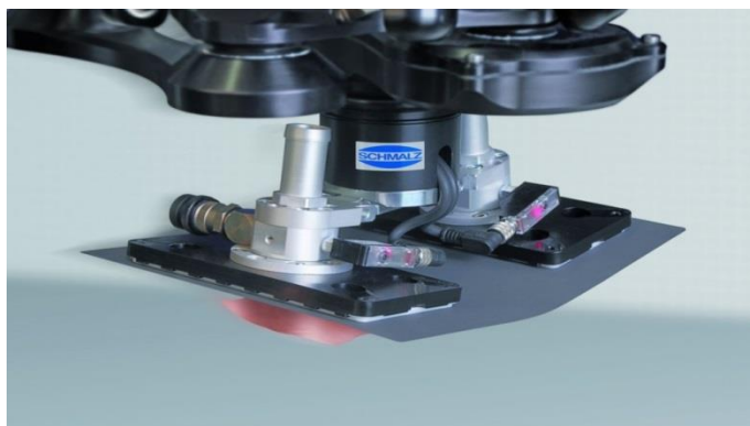
Obr. 9) Aktivní podtlakový manipulační koncový efektor [17]
