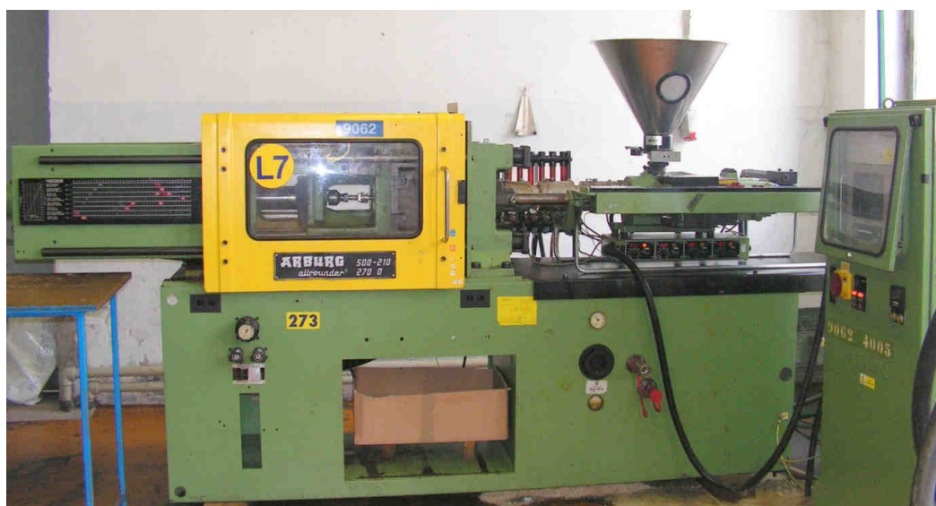
Obr. 34. Vstřikovací stroj Arburg allrounder 270-210-500
