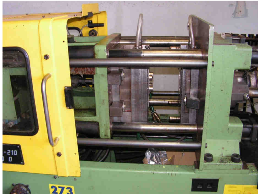
Obr. 31. Uzavírající jednotka s upnutou formou
