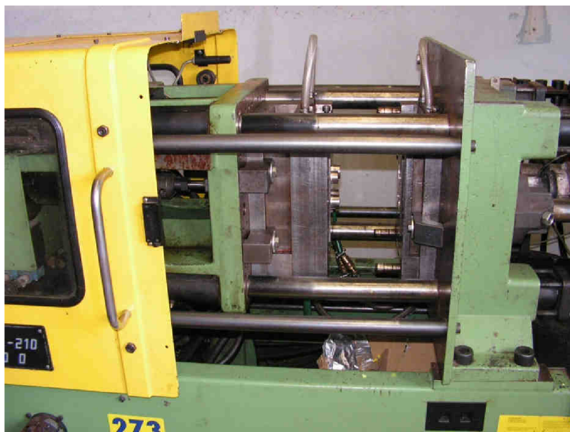
Obr. 31. Uzavírající jednotka s upnutou formou
