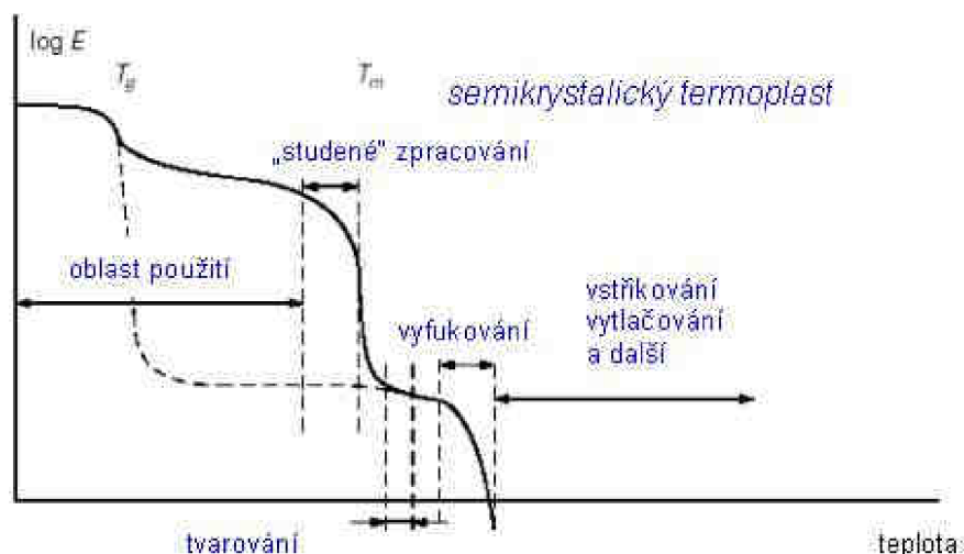
Obr. 1. Teplotní oblasti pro vybrané technologie zpracování plastů [3]
