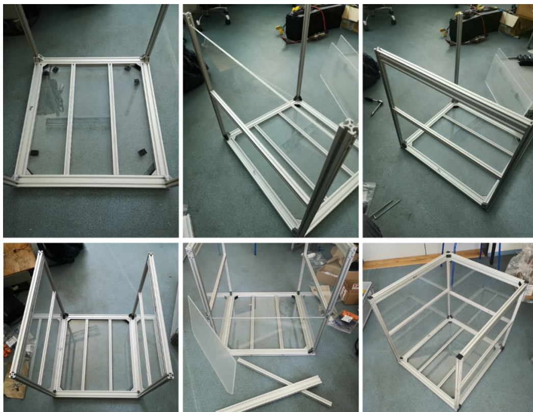
Obrázek 35 – Průběh sestavování boků a zadní části rámu
