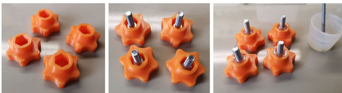
Obrázek 28 – Zalití šroubů epoxydovým lepidlem
