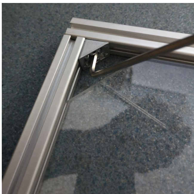
Obrázek 30 – Prostor pro utahování šroubů rohovníků
