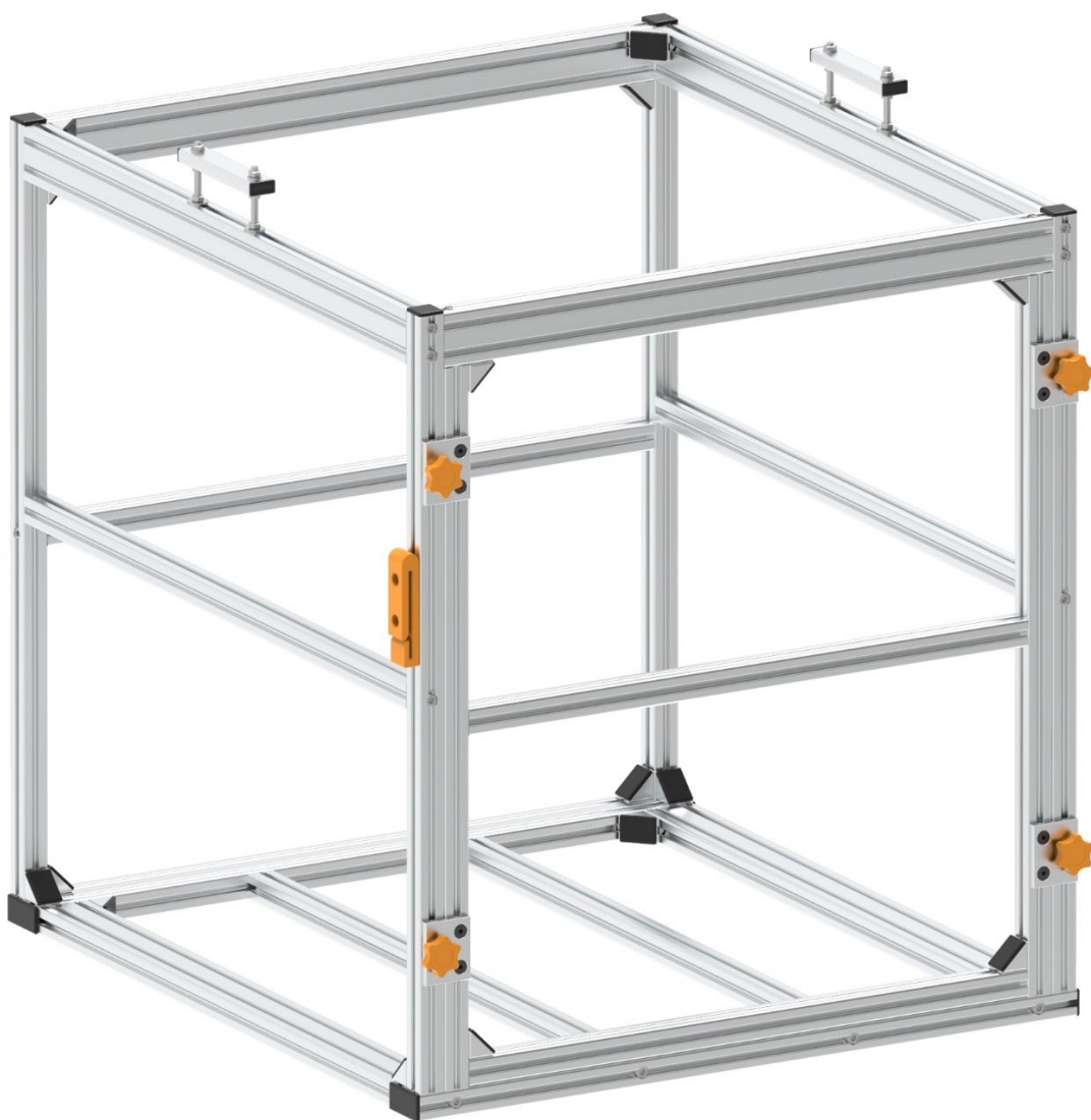
Obrázek 13 – Renderovaný 3D model sestavy rámu
