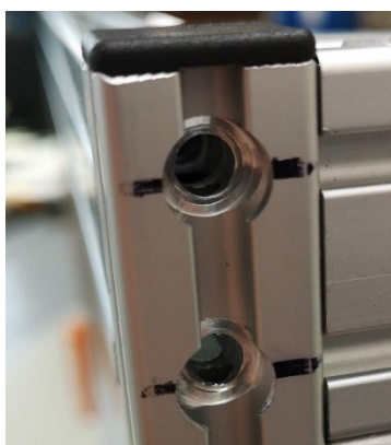
Obrázek 26 – Detail obrobeného profilu 20x20
