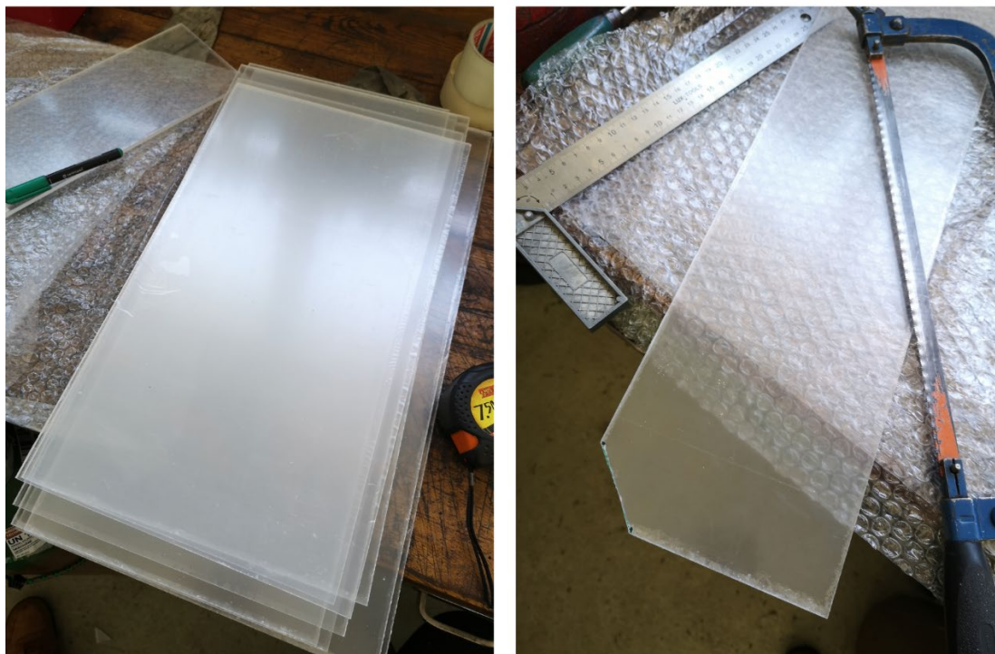
Obrázek 29 – Nařezané PMMA desky a ukázka seříznutého rohu
