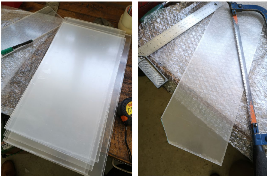
Obrázek 29 – Nařezané PMMA desky a ukázka seříznutého rohu
