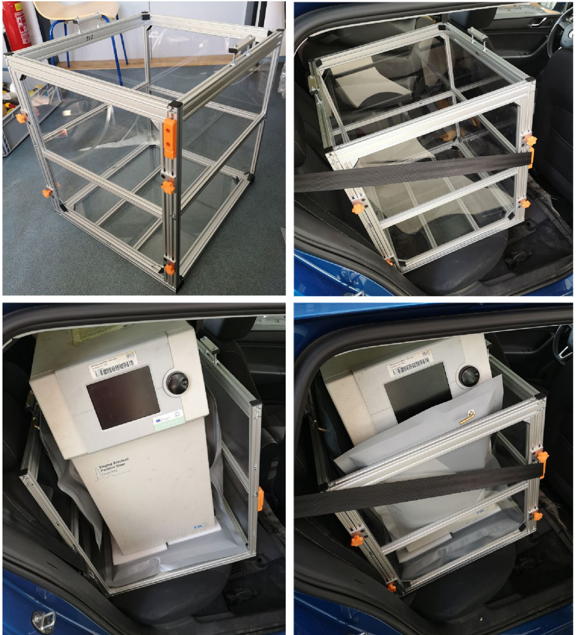
Obrázek 37 – Výsledný sestavený rám a jeho umístění v automobilu
