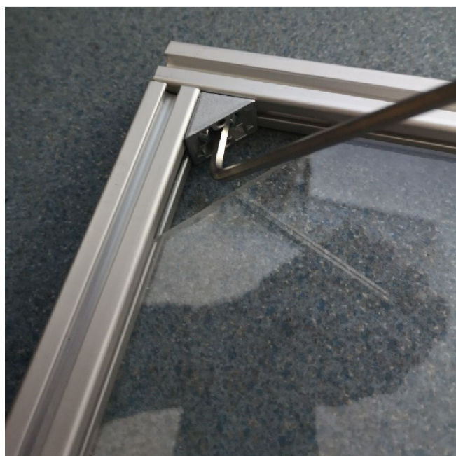
Obrázek 30 – Prostor pro utahování šroubů rohovníků
