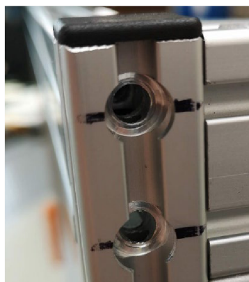
Obrázek 26 – Detail obrobeného profilu 20x20
