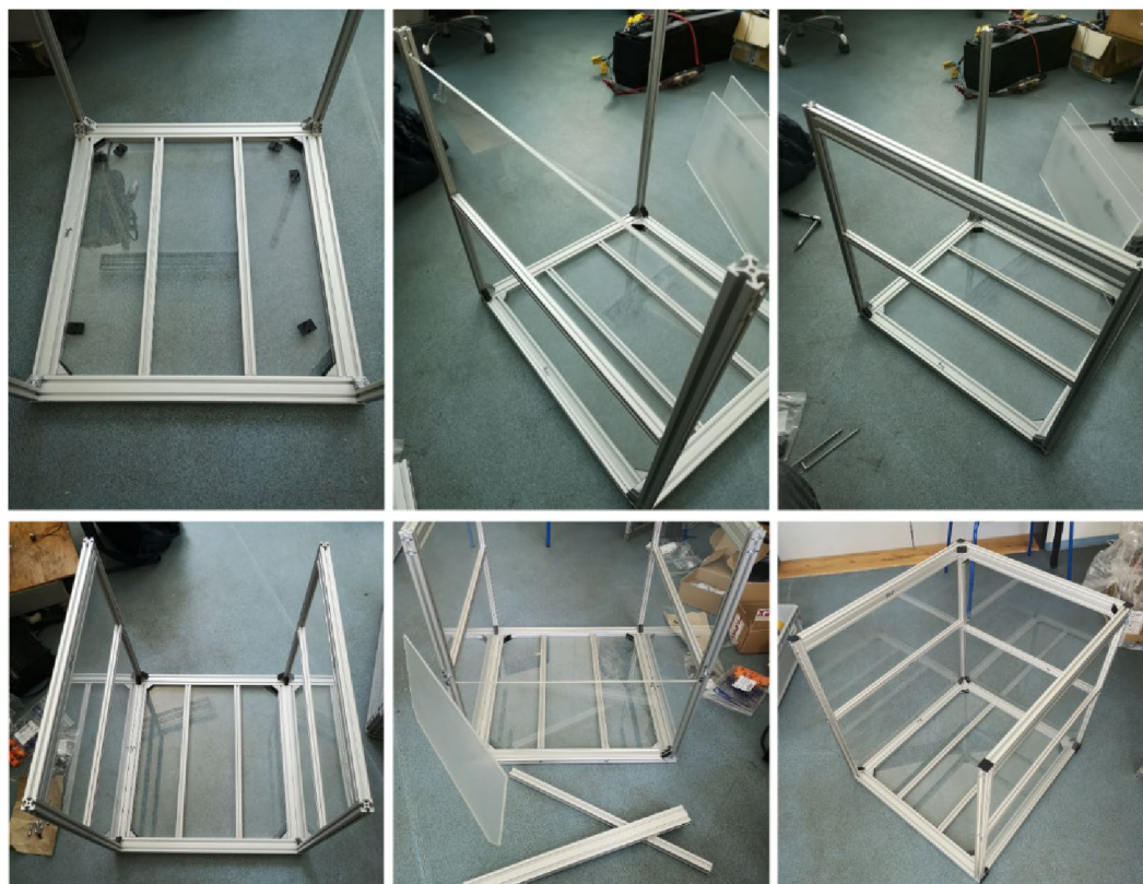
Obrázek 35 – Průběh sestavování boků a zadní části rámu
