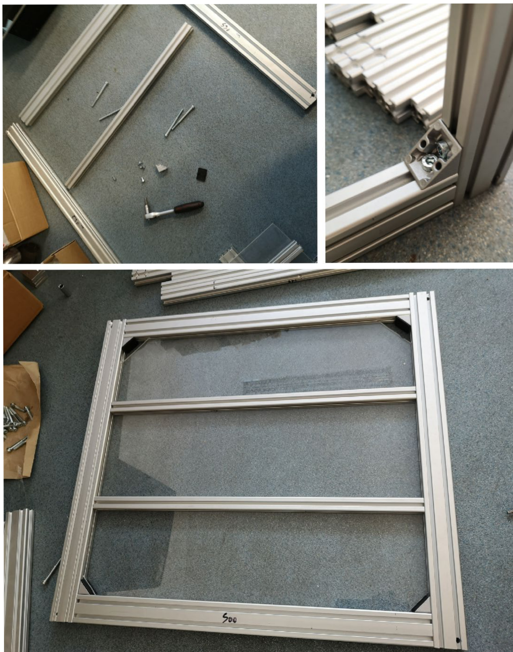
Obrázek 33 – Sestavování konstrukce dna, detail spojení profilů rohovníkem a výsledek
