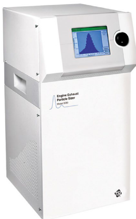
Obrázek 7 – Fyzické provedení částicového analyzátoru TSI EEPS TM 3090 [17]
