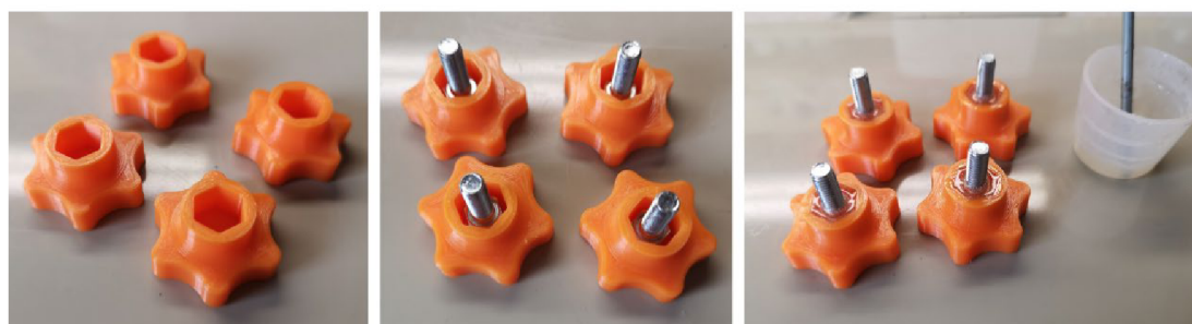
Obrázek 28 – Zaliti šroubů epoxydovým lepidlem
