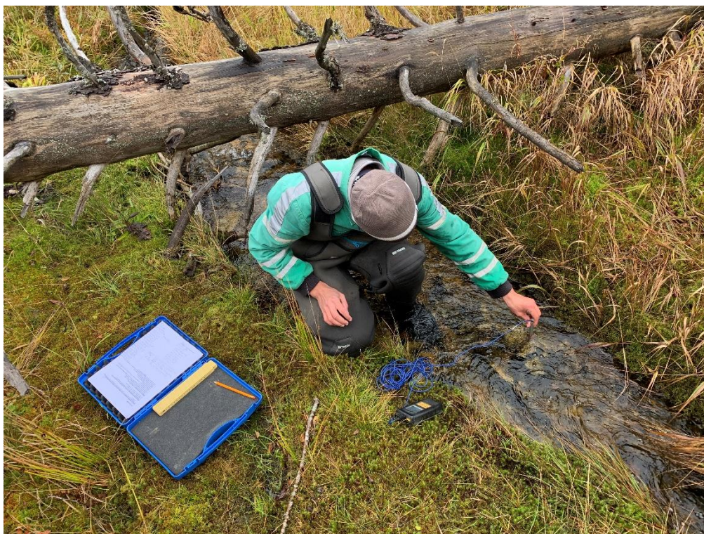
Obrázek 20: Měření rychlosti proudění, levostranný přítok do jezera Laka, září 2022 (foto: Jan Hůda).
