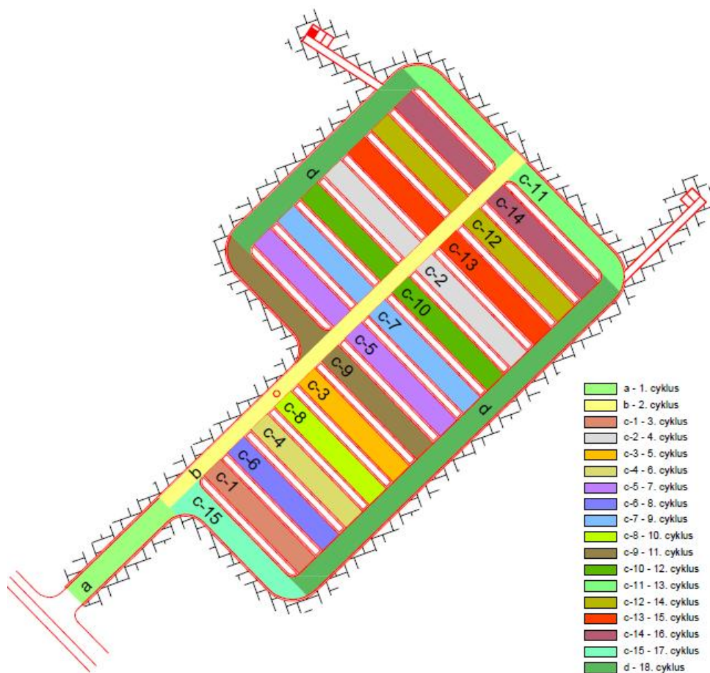
Obr. 8.3 Schéma posloupnosti ražby v cyklech 1 až 18
