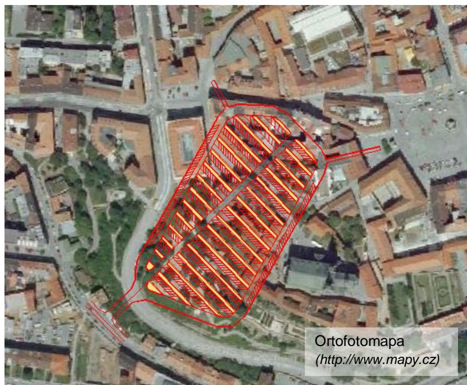
Obr. 4.12 VARIANTA A - Půdorysné řešení podzemní garáže (ortofoto mapa)
