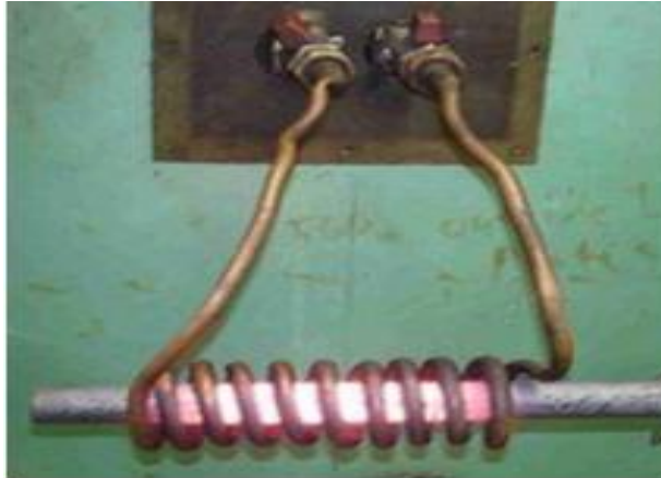
Obr. 12 Ohřev symetrické válcové tyče [11]
