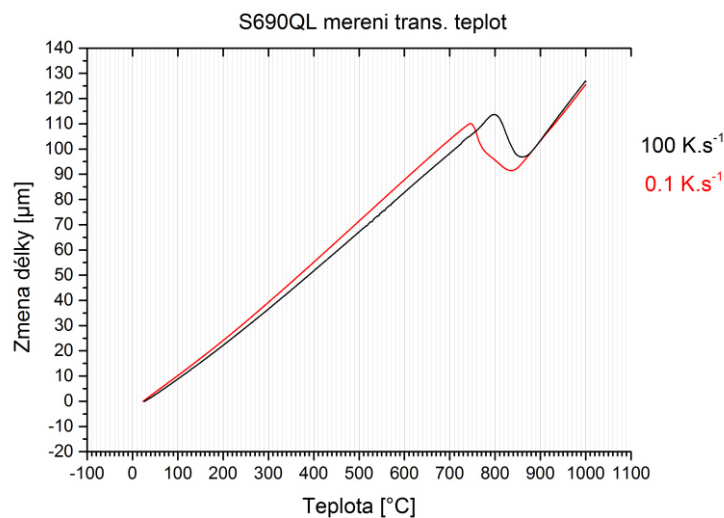
Obr. 30 Rozdíly mezi dilatometrickou křivkou při rychlosti 0,1 a 100 \text{ K}\cdot\text{s}^{-1}
