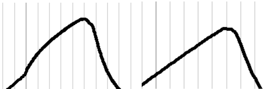
Obr. 27 Detail vrcholu křivky při nekonstantním ohřevu (vlevo), detail vrcholu křivky při konstantním ohřevu (vpravo)
