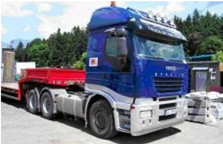
Obrázek 43: IVECO STRALIS 6x4 + speciální návěs GOLDHOFER [4]
