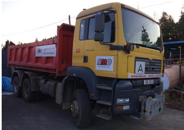
Obrázek 47: MAN TGA 6x6 třístranný sklápěč [4]
