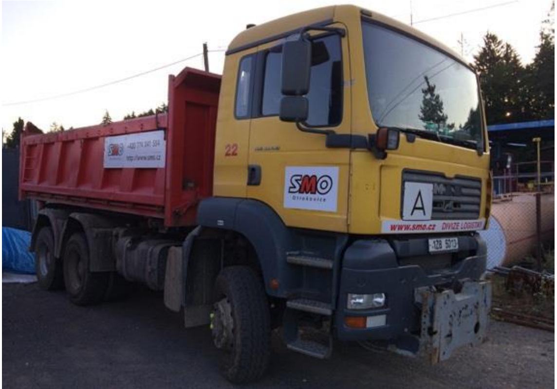
Obrázek 39: MAN TGA 6x6 třístranný sklápěč
