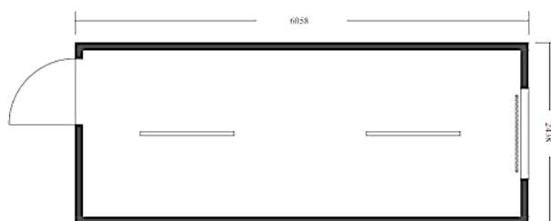
Obrázek 28: Obytný kontejner C3L 01 [14]
