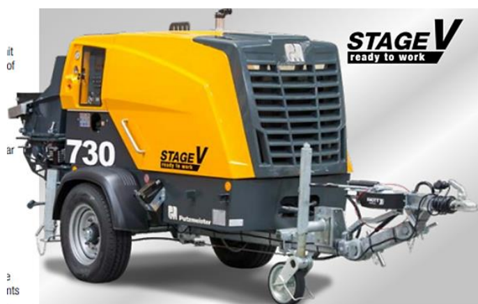
Obrázek 51: Pumpa na beton Putzmeister P730 TD [7]
