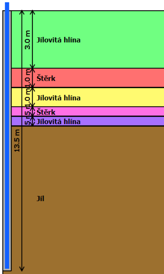
Obrázek 6.2 Schéma geologického profilu IT1 a IT3
