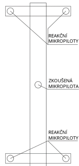
Obrázek 5.3 Schéma tlakové zkoušky
