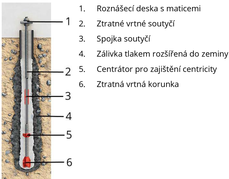
Obrázek 3.5 Mikropilota Ischebeck TITAN, dostupné z: TITAN micropiles an Innovation prevails, https://www.ischebeck.de/en/service/downloads/
