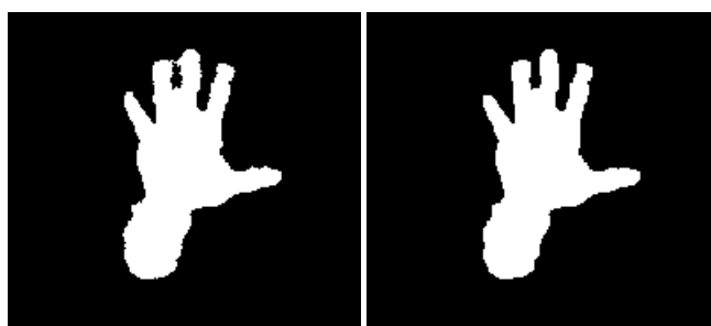
Obrázek 3.7: Vlevo obraz před provedením morfologických operací. Vpravo po aplikaci morfologických operací.
