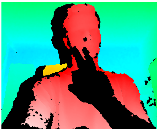
Obrázek 2.8: Hloubková data převedena na 2d obraz, barevný přechod znázorňuje vzdálenost
