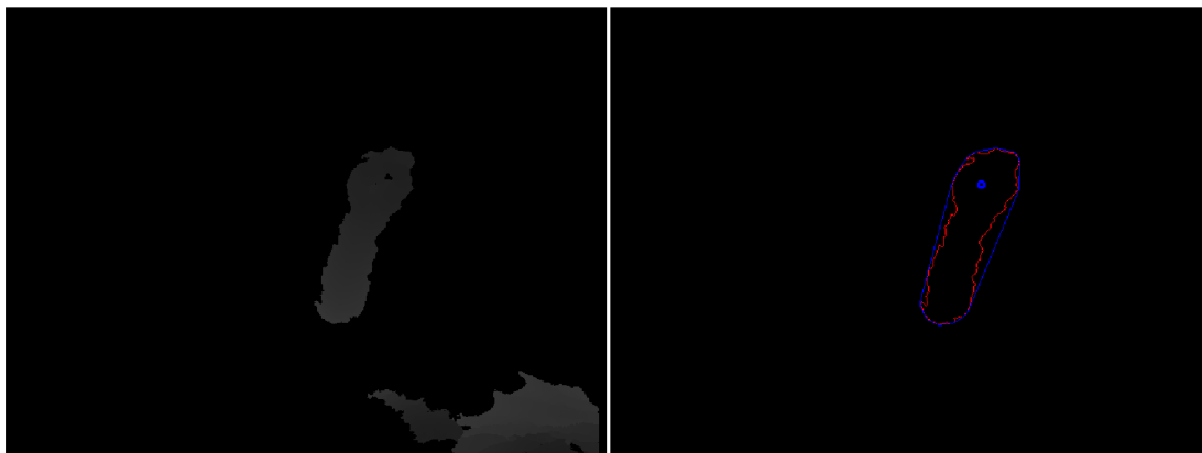
Obrázek 3.10: Vlevo zdrojový obraz pro detekci pěsti. Vpravo detekovaná pěst.
