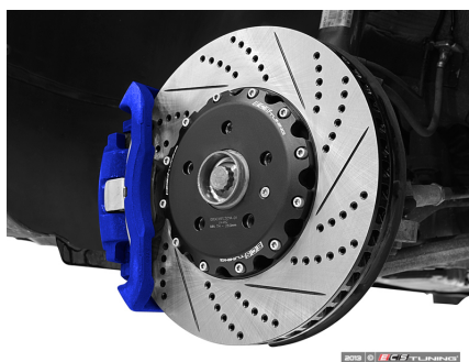
Obr. 2.3: Brzdový kotúč, ktorý je ventilovaný, drážkovaný, aj vrtaný. 3
