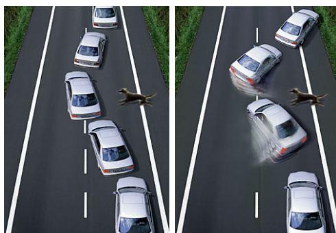
Obr. 2.5: Vplyv ABS na stabilitu vozidla v praxi, vľavo s ABS, vpravo bez ABS. 5
