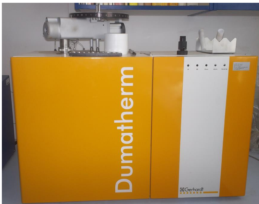
Obrázek 7: Analýza dusíku na přístroji Dumatherm
