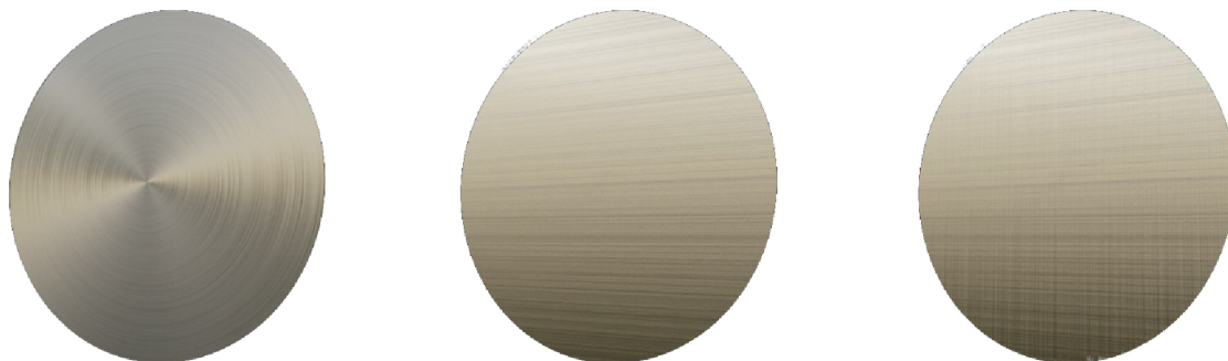
Obrázek 5.2: Anisotropie – škrábance v povrchu materiálu výrazně ovlivňují jeho vzhled.
