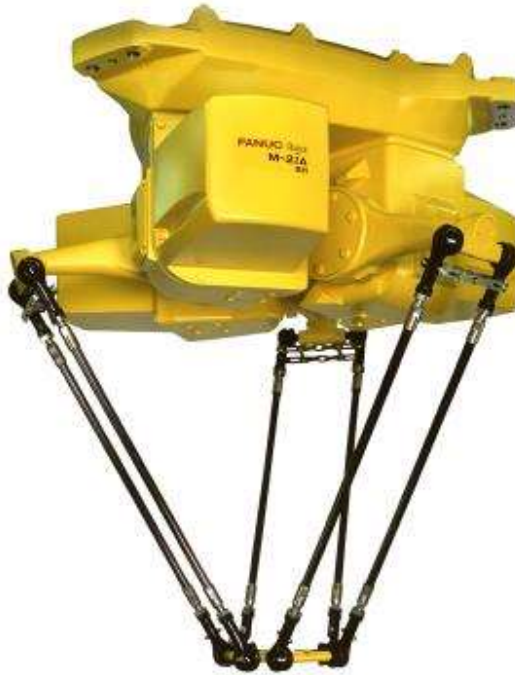
Obr. 19) Paralelní robot FANUC M-2 ia 6H [50]
