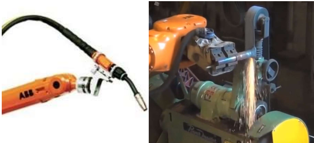
Obr. 30) a) svařovací efektor [63] b) robot jako obsluha pátové brusky [64]
