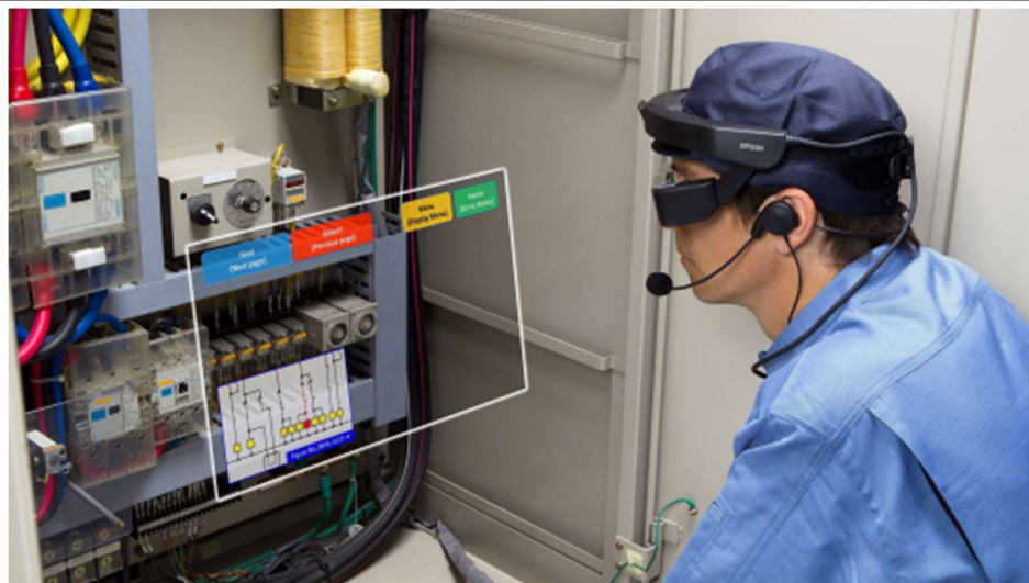
Obr. 13) Vizualizace elektroinstalace zprostředkovaná chytrými brýlemi [46]
