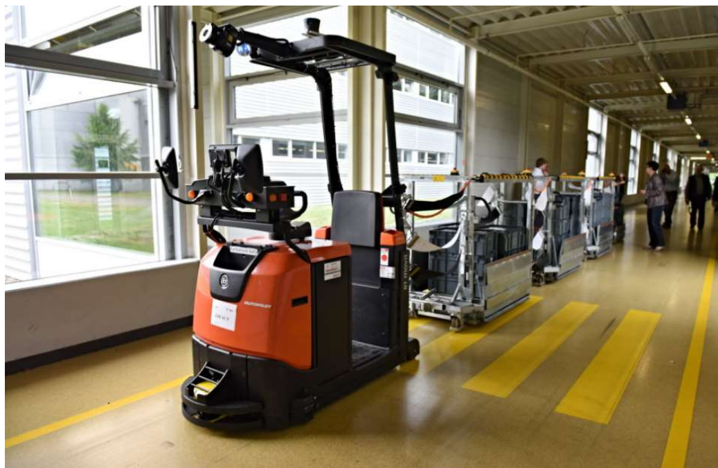
Obr. 17) Automatizovaný dopravní vozík ve firmě Bosch Diesel s.r.o. [49]
