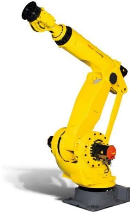
Obr. 18) Univerzální šestiosý sériový robot FANUC M-900iB/280 [51]
