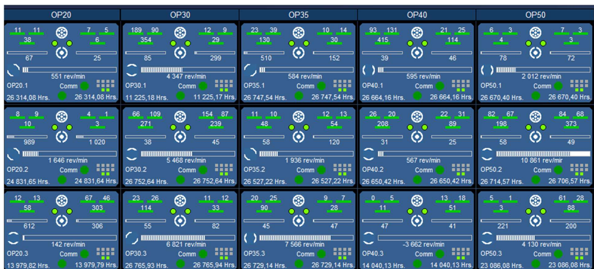
Obr. 6) Rozhraní online vibrodiagnostiky obráběcích vřeten na strojích Grob BZ 550 ve firmě Bosch Diesel s.r.o [41]
