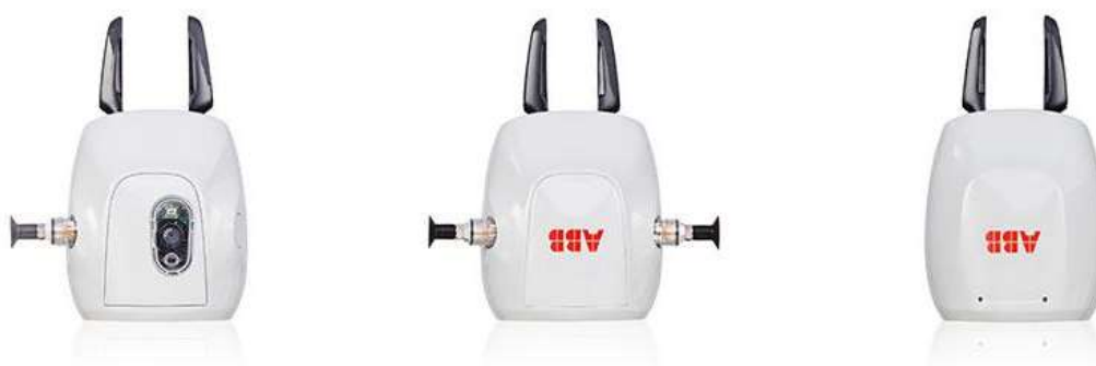
Obr. 32) Možnosti úpravy efektoru ABB YuMi [10]
