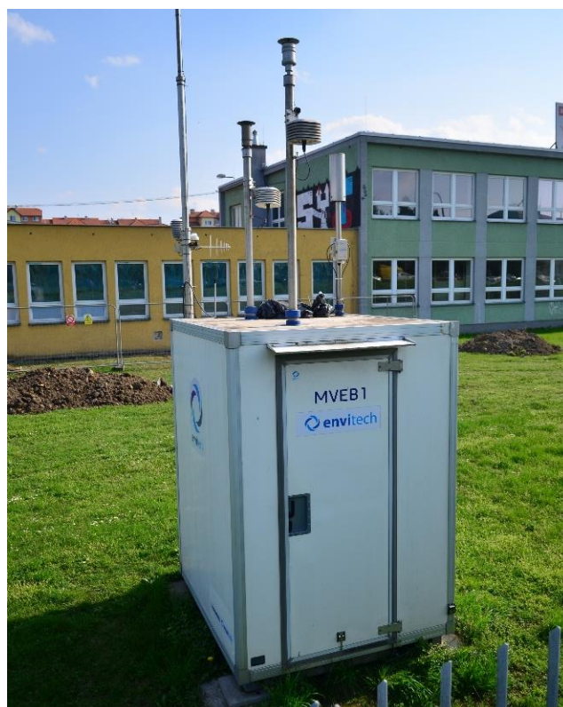
Obr. 4: Měřicí stanice imisních a meteorologických veličin (foto Tereza Nýdecká).
