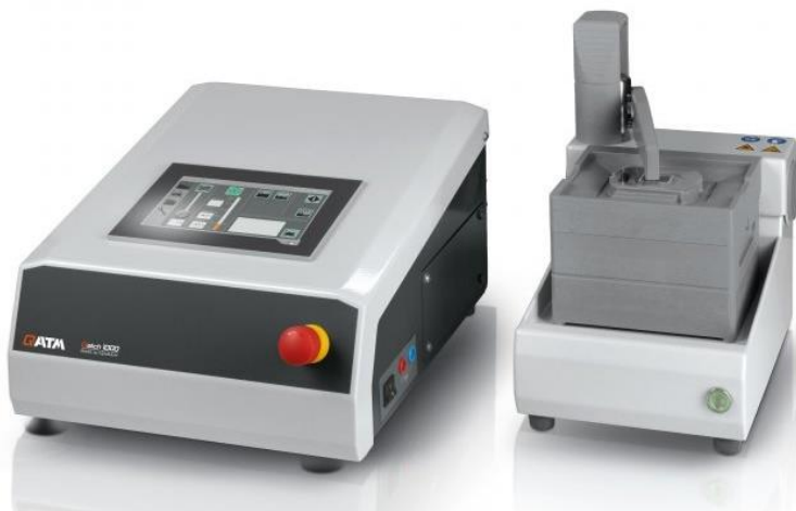
Obr. 4) QETCH 1000 (Kristall 680) – laboratorní elektrolytická leštička [13]
