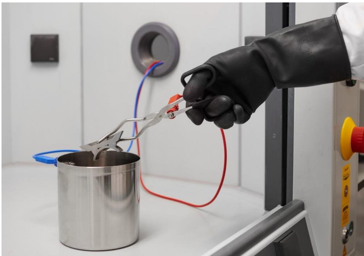
Obr. 14) Laboratorní aparatura pro elektrochemické leštění [13]
