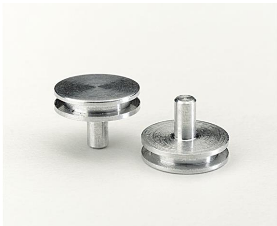
Obr. 11) Nosič vzorku pro SEM [40]
