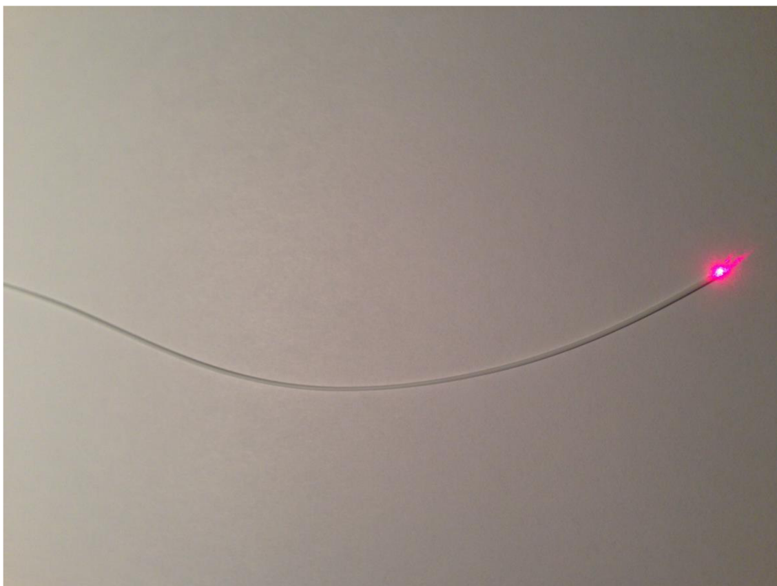
Obr. 4.8: Vedenie svetla optickým vodičom bez výraznejších ohybov
