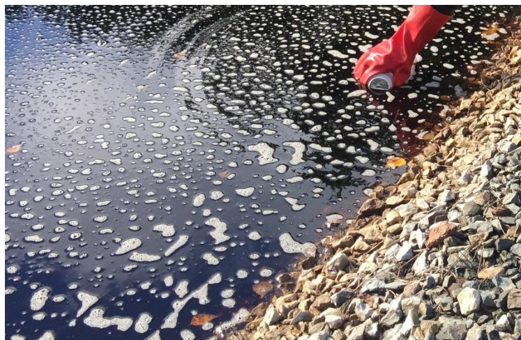
Obrázek 61: Odběr průsakové vody
