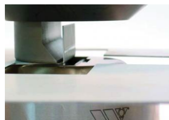
Obr. 10 Ohýbání na vysekávacím stroji [24]
