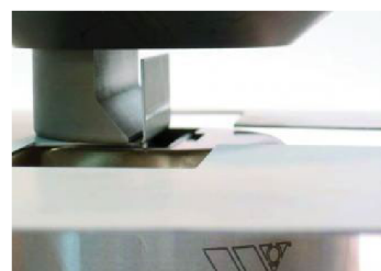
Obr. 10 Ohýbání na vysekávacím stroji [24]
