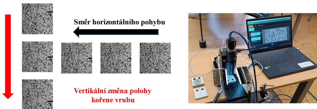
Obrázek 32: Změna polohy kořene vrubu (vlevo) a snímací aparatura (vpravo)
