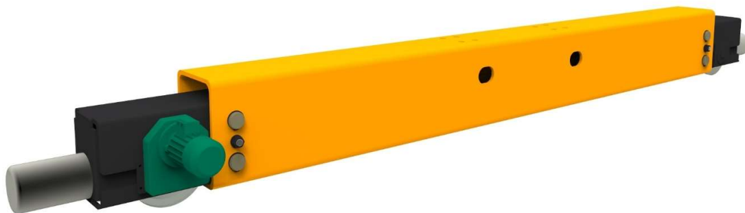
Obr. 22 Model sestavy příčnicku
