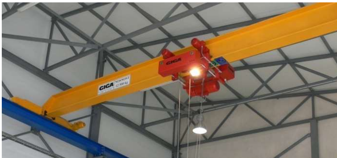
Obr. 3 Podpěrný mostový jeřáb jednonosíkový [18]
