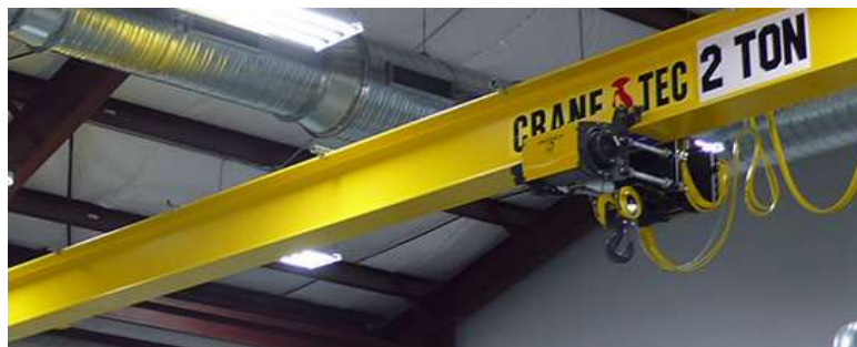
Obr. 6 Mostový jeřáb s plnostěnným nosníkem [22]
