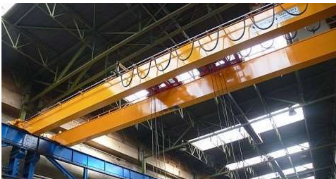
Obr. 5 Mostový jeřáb dvounosníkový [20]
