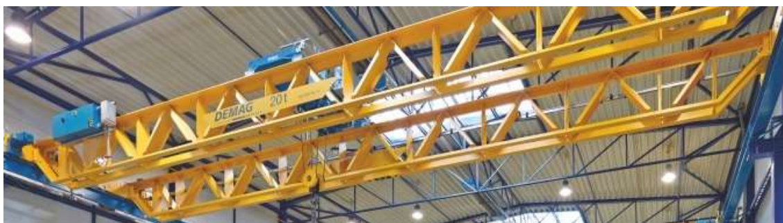
Obr. 7 Mostový jeřáb s příhradovým nosníkem [23]
