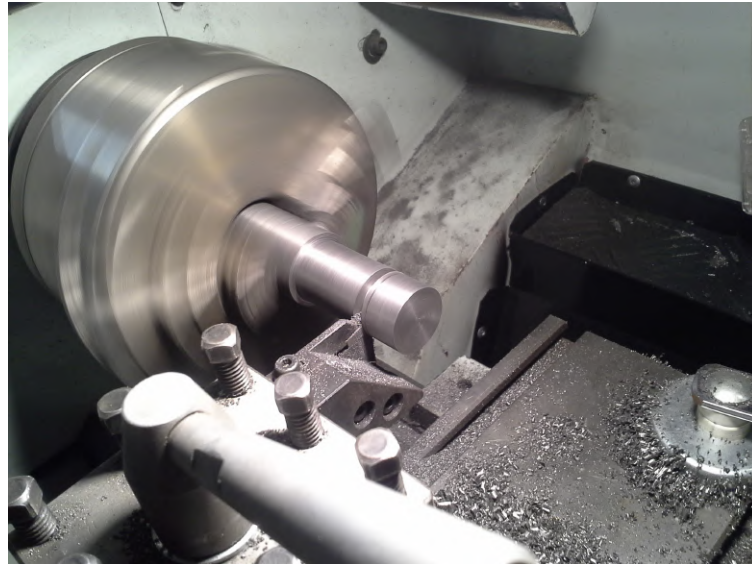
Obr. 3.33: Sústruženie jadier elektromagnetov.
