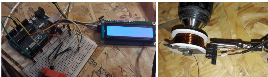
Obr. 3.32: Navíjanie elektromagnetov a počítanie závitov.
