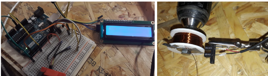
Obr. 3.32: Navíjanie elektromagnetov a počítanie závitov.
