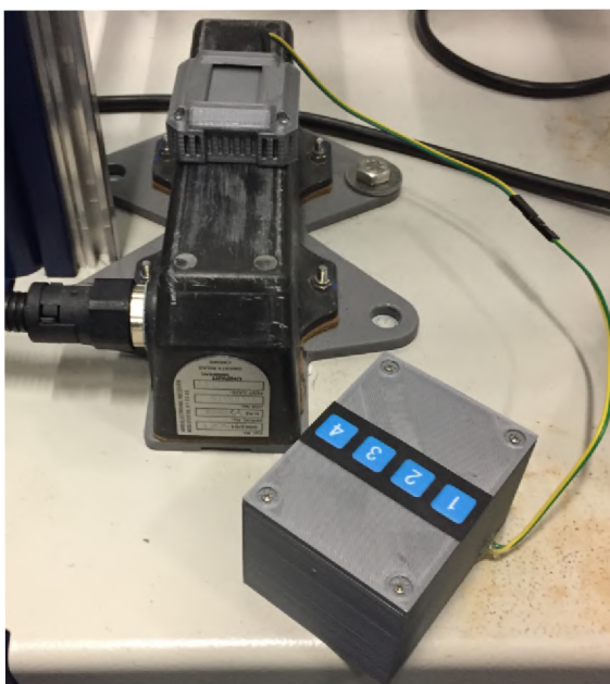
Obr. 4.6: Overenie funkčnosti elektromagnetu na AWS prijímači.
