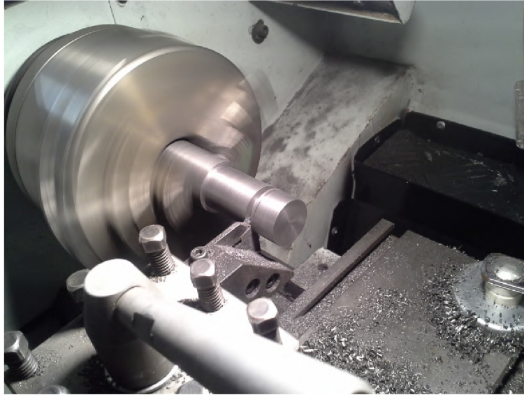
Obr. 3.33: Sústruženie jadier elektromagnetov.
