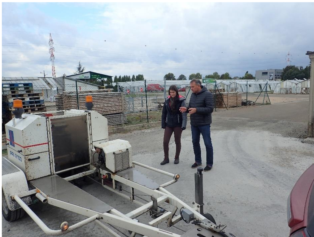
Obr. 42: Přívěs FWD pro měření únosnosti vrstvy
