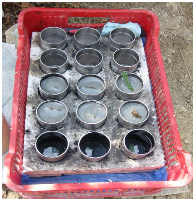
Obr. 7: Zkušební válečky pro zkoušky pevnosti v tlaku odebrané na stavbě (24)
