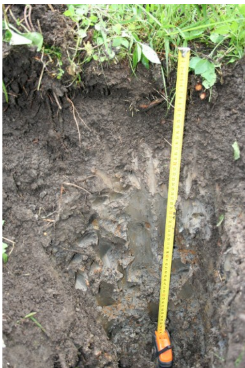
Obr. 18: Lokalita č. 5 - mocnost půdních horizontů po odebrání vzorků, půdní typ glej, forma humusu hydromull; foto vlastní (1. 6. 2012)
