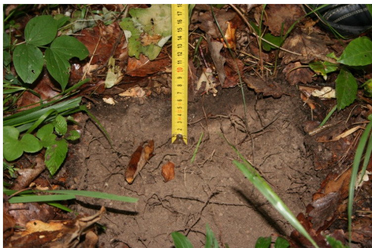
Obr. 14: Lokalita č. 4 - mocnost půdních horizontů po odebrání vzorků, půdní typ rendzina kambická na vápenci, forma humusu mull; foto vlastní (31. 5. 2012)
