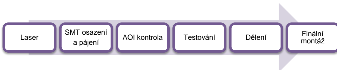
Obrázek 4: Výrobní proces za využití strojního (SMT) osazení
